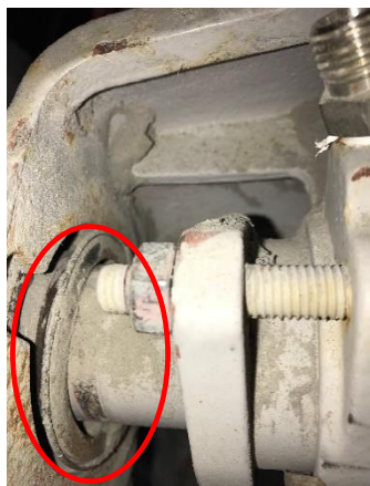
①粉漏れがベアリングへ到達
