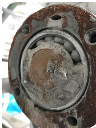
②ベアリング破損
